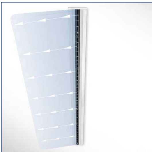
Горизонтальная подача воздуха в одном направлении влево
