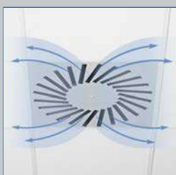
Горизонтальная подача воздуха в двух направлениях
