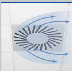
Горизонтальная подача воздуха в одном направлении
