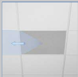
Горизонтальная подача воздуха в одном направлении
