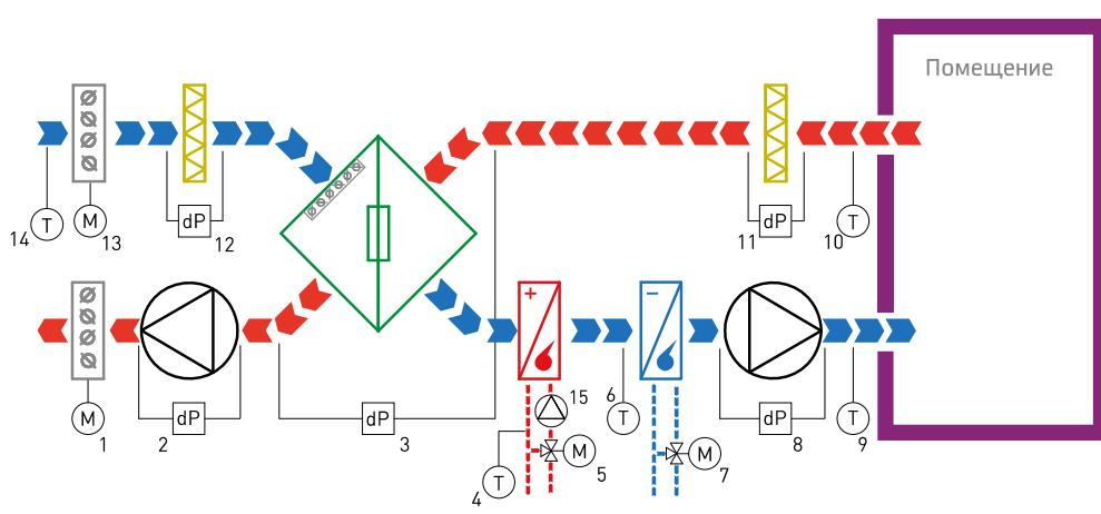
**1, 13** — Электропривод воздушной заслонки (24В или 230В); **2, 8** — Дифференциальное реле давления (контроль работы вентилятора); **3** — Дифференциальное реле давления (контроль обмерзания рекуператора);
