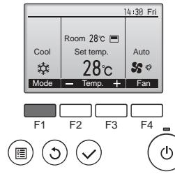
Нажмите кнопку [F1] для перехода между режимами работы в порядке "Cool" (Охлажд.), "Dry" (Сушка), "Fan" (Вент.), "Auto" (Авт.) и "Heat" (Нагрев). Выберите желаемый режим работы.
