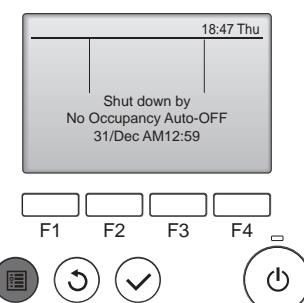
④ Данное сообщение слева будет отображено в случае автоматического отключения с использованием функции No occupancy Auto-OFF (Автовключение при отсутствии людей в помещении).
