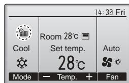
Когда отобразится в главном окне, которое настроено на отображение в режиме "полный", то система находится под централизованным управлением и значок фильтра не может быть сброшен.
