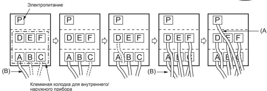
Провод соединения внутреннего/наружного приборов
