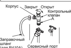
Если при креплении контрольного клапана к сервисному порту прилагать чрезмерное давление, сердечник клапана может деформироваться или открыться. Это может привести к утечке газа.
