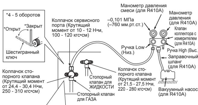
Меры предосторожности при использовании контрольного клапана
