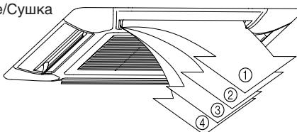
● Направление потока воздуха устанавливается автоматически, как показано, в соответствии с выбранным типом эксплуатации.
