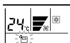
Чтобы выбрать устройство для определения температуры внутри помещения – внутренний блок (дистанционный датчик) или пульт дистанционного управления, нажмите кнопку ECONOMY (режим энергосбережения) и удерживайте ее более 2 секунд.
