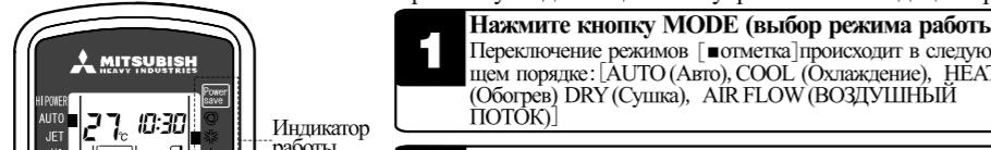
**1** Нажмите кнопку MODE (выбор режима работы). Переключение режимов [■ отметка] происходит в следующем порядке: [AUTO (Авто), COOL (Охлаждение), HEAT (Обогрев), DRY (Сушка), AIR FLOW (ВОЗДУШНЫЙ ПОТОК)].
