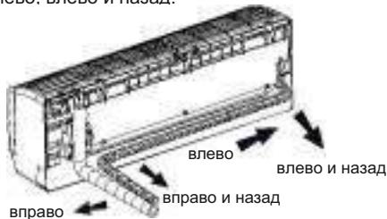
2. В зависимости от выбора направления прокладки трубопровода (вправо или влево), образуйте соответствующее отверстие в нижней части корпуса блока
