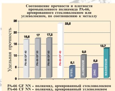
Таким образом, при одинаковой прочности изделия из пластика весят значительно меньше, чем те же, но из металла, практически в 3-4 раза. Уменьшение веса воздушных завес, изготовленных из промышленного пластика, позволяет сократить транспортные расходы по их перевозке и доставке, что обеспечивает низкую цену самих изделий при неизменности их качественных характеристик.
