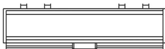
Воздушные завесы с водяным нагревом имеют высокую скорость воздуха на выходе из сопла, что позволяет устанавливать их на высоту проема выше 8 метров.
