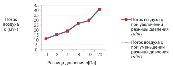
График 3. Зависимость потока воздуха q (м 3 /ч), протекающего через клапан VT 501, от разницы давления p(Па)
