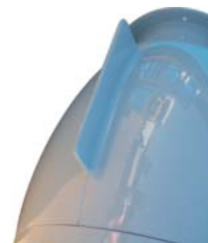
монтажная лапа вентилятора для обсервации при монтаже
