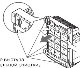
Отсоедините четыре выступа фильтра предварительной очистки.
