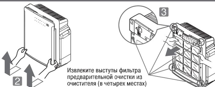
Извлеките выступы фильтра предварительной очистки из очистителя (в четырех местах)
