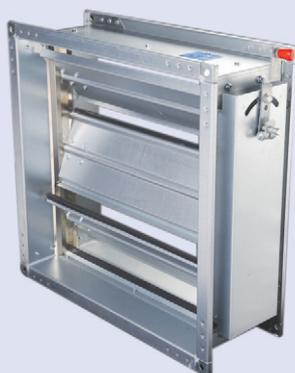
C3: конструкция с профилированными створками и силиконовым уплотнением, что соответствует требованиям устойчивости к высоким температурам  $280$  °C/1 ч
