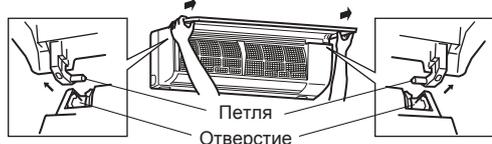
1. Поднимайте переднюю панель до тех пор, пока она не зафиксируется на месте со щелчком.
