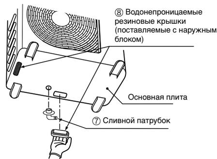
2. Установка сливного патрубка ⑦ и имеющегося в продаже сливного шланга (с внутренним диаметром 16 мм) и слив воды.
