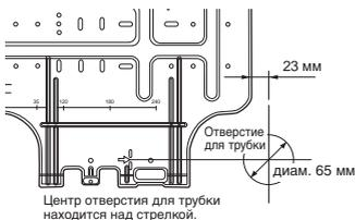
1. После определения положения отверстия для трубки на установочной пластине (➔), просверлите отверстие для трубки (диам. 65 мм) с небольшим наклоном в сторону наружного блока.
