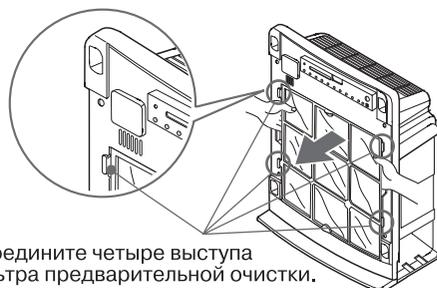
Отсоедините четыре выступа фильтра предварительной очистки.
