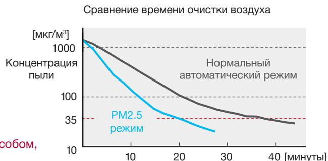
Рабочий режим автоматически изменяется в соответствии с концентрацией микрочастиц.
